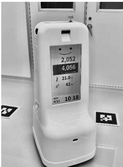
クリーンルーム清浄度測定ロボット
